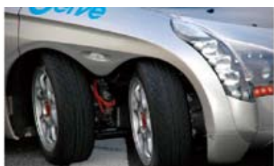
車輪に直接モーターが組み込まれている
