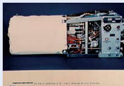
スペースシャトルで使われている米国 UTC Power 社の燃料電池
