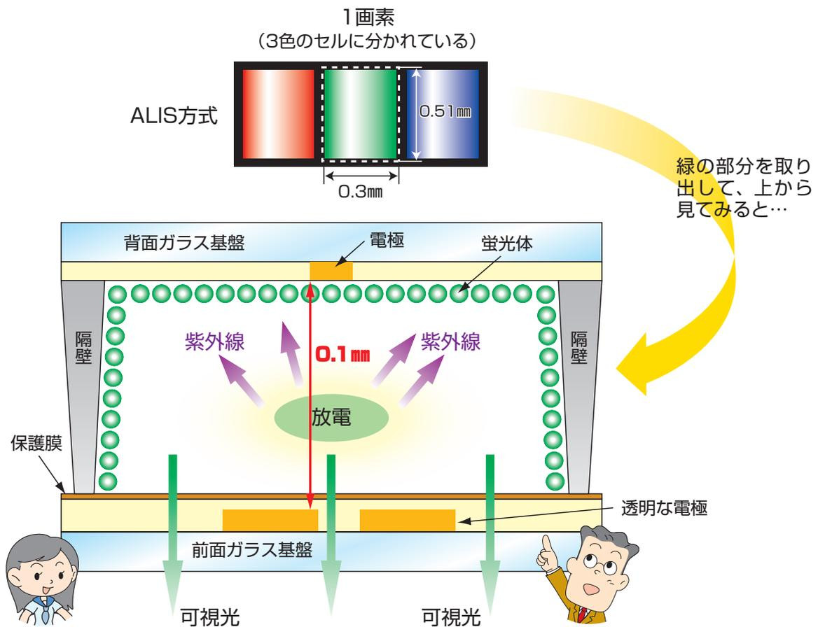
1980年代、川崎市中原区上小田中の株式会社富士通研究所が開発に成功したカラープラズマディスプレイパネル（現在は富士通日立プラズマディスプレイ株式会社で開発・生産）は、小さなガラスで区切られた部屋がたくさん集まって出来ています。この小さな部屋をセルとよび、200万画素のプラズマディスプレイには600万のセルがあります。セルの中には電極が並んでいて、電極に電圧がかかると電極間に放電が起きて光ります。つまり、小さなセルの中で雷を発生させるのです。放電をおこさせる電極の間隔はわずか0.1ミリメートル程度です。
