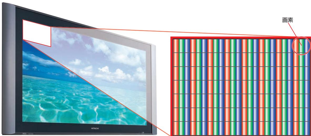
放送局で撮影された映像は、撮影カメラの中で電気信号に変換され、電波によって送信(伝送)されます。家庭のテレビは、受信した電波(電気信号)を光に変換し映像として画面に表示します。
