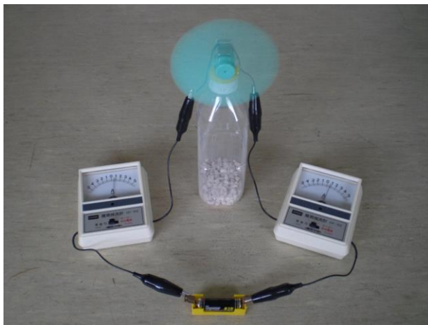
検流計の針がどちらも同じ方向に傾くようにセットする。
