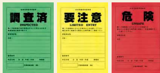
応急危険度判定の判定標識
