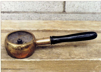
火のし 中に炭 すみ を入れて布の しわをのばす道具
